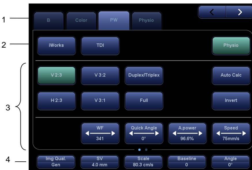
1. Область отображения режима (или закладки главных функций): отображает текущий режим. Коснитесь этой закладки, чтобы выбрать соответствующий режим.
