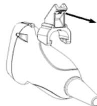
Снимите опору держателя направляющих иглы с датчика.
