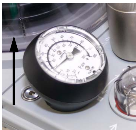
РИСУНОК 7-15 Извлечение манометра PAW
