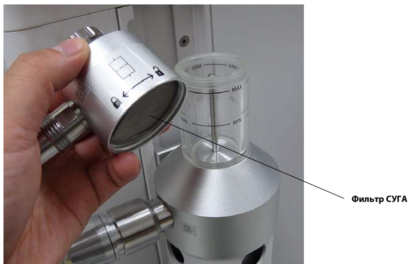
РИСУНОК 7-24 Снятие крышки СУГА/проверка фильтра СУГА
