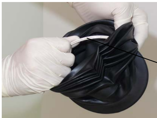
РИСУНОК 7-8 Удаление адаптерного кольца сильфона
