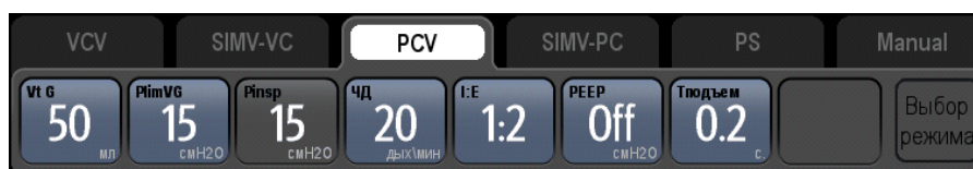
РИСУНОК 5-12 Вкладка режима вентиляции с регулируемым давлением
