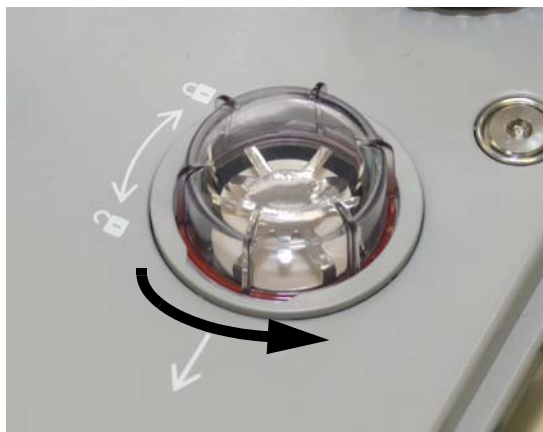
РИСУНОК 7-11 Снятие крышки клапана
