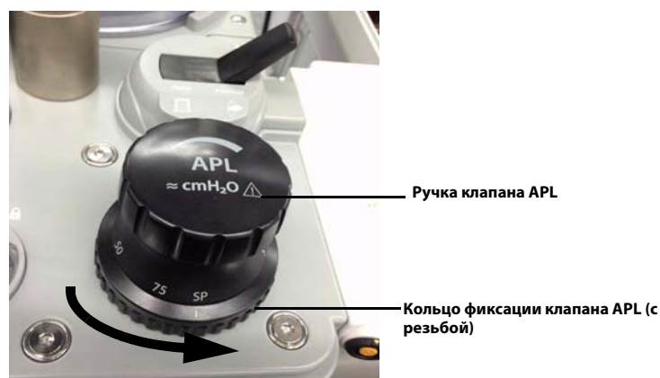
РИСУНОК 7-14 Извлечение клапана APL
