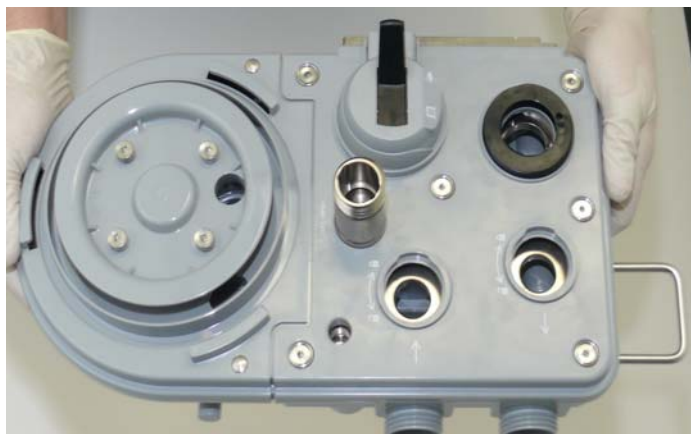
РИСУНОК 7-21 Снятие блока дыхательного контура, вид сверху
