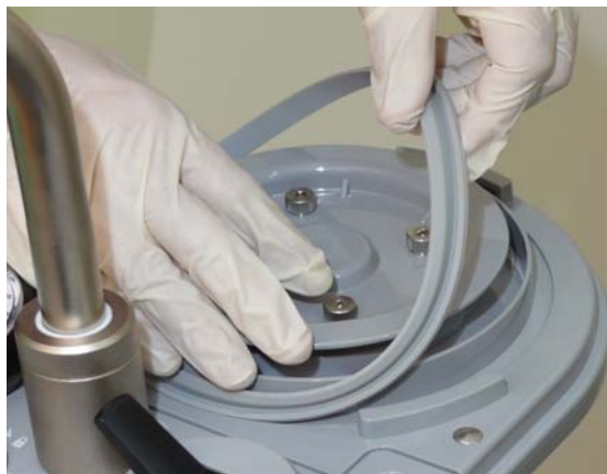
РИСУНОК 7-9 Удаление O-кольца купола сильфона
