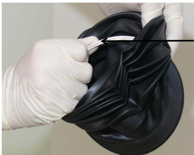
Кольцо верхней панели сиффона. Бороздки на соединительном кольце повёрнуты вниз.
