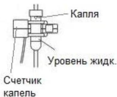
Рисунок 11. Схема установки счетчика капель
