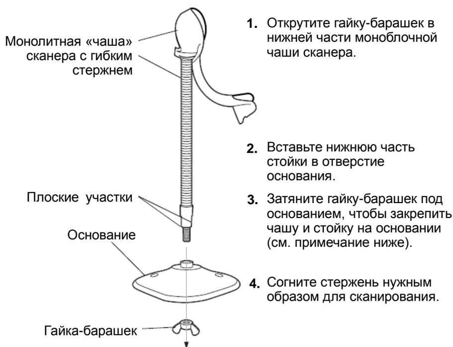
ПРИМЕЧАНИЕ: перед затягиванием гайки-барашка под основанием убедитесь в том, что конец гибкого стержня с плоской поверхностью плотно вошел в пазы основания.
