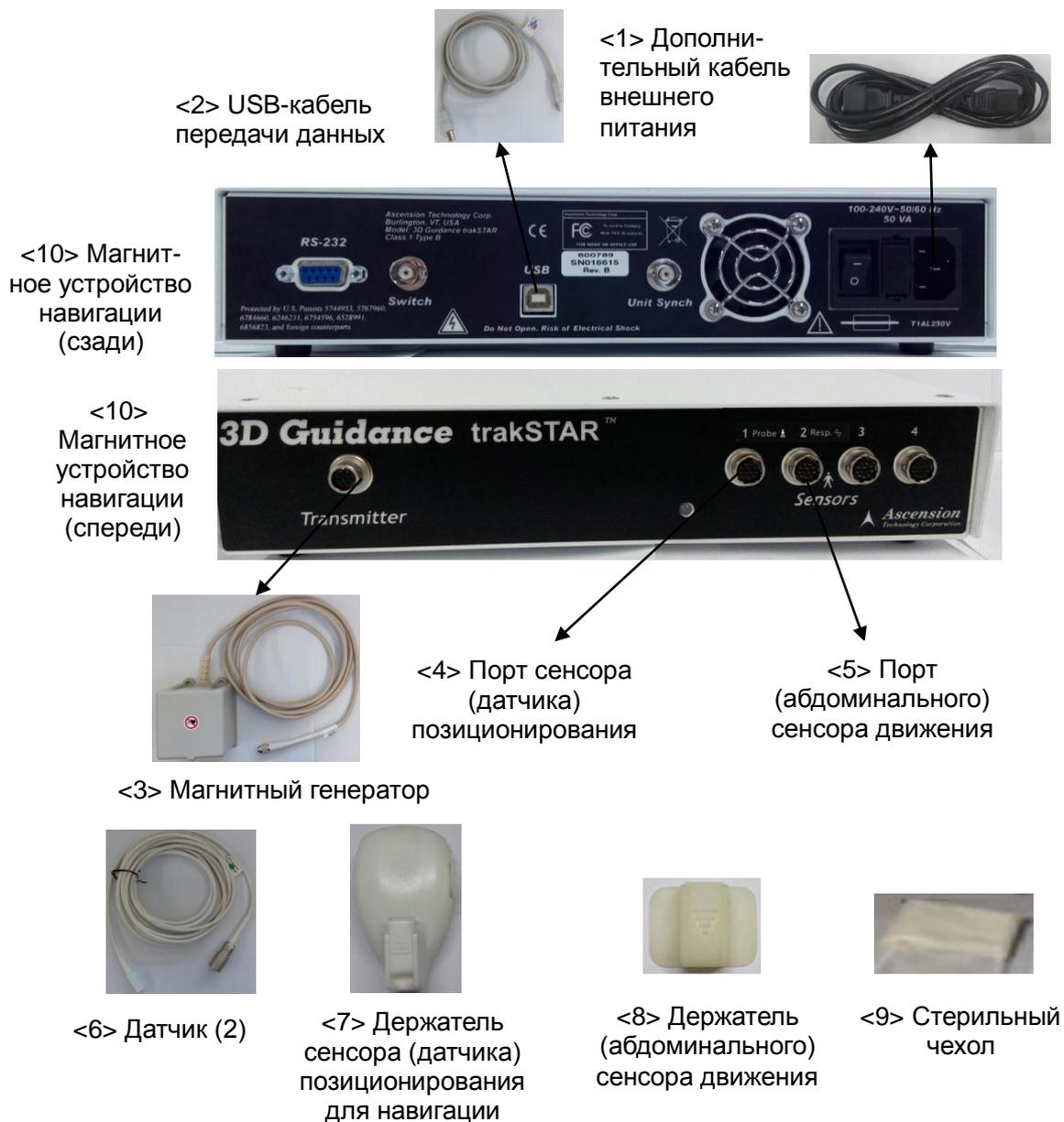
В настоящем руководстве приводится подробное описание магнитного устройства навигации. См. таблицу ниже.
