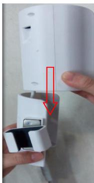
2. Вставьте нагреватель геля в паз вдоль края панели управления (в направлении, указанном стрелкой). Нагреватель геля располагается ниже уровня панели управления.
