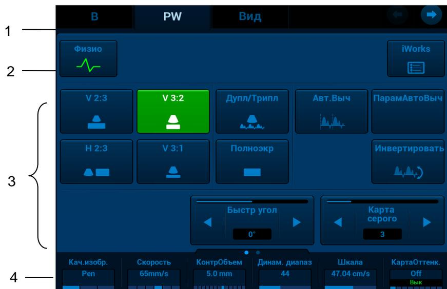
1. Область отображения режима (или вкладки основных функций): отображает текущий режим; нажмите вкладку, чтобы перейти в соответствующий режим.
