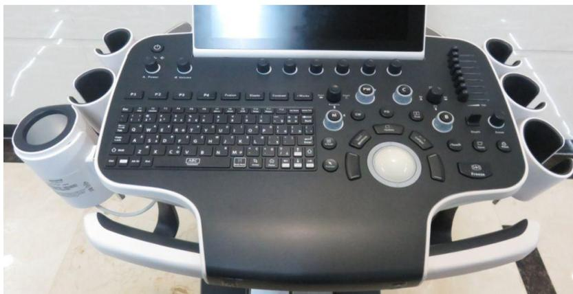
Как показано на рисунке выше, нагреватель устанавливается на левой стороне панели управления, в положение для установки флакона с гелем.
