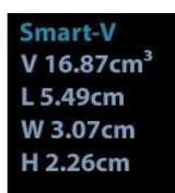
По завершении расчета в верхней правой части экрана отобразится следующий результат. Где L, W и H — это длины 3 диаметров аппроксимирующего эллипсоида. V — рассчитанное значение объема
