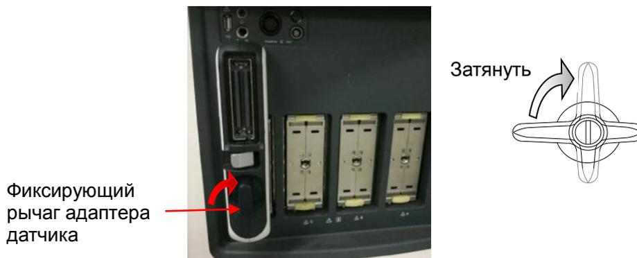
3. Вставьте разъем датчика TEE в гнездо датчика TEE, так чтобы кабель находился сверху, затем переведите рычаг в положение блокировки, чтобы зафиксировать датчик TEE и завершить установку адаптера датчика и датчика TEE.
