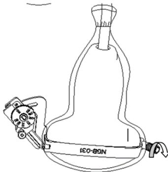
4. С помощью поворотного регулятора выберите нужный сдвиг в соответствии с типом иглы.
