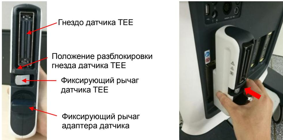
2. Переведите фиксирующий рычаг адаптера датчика в вертикальное положение, повернув его на 90° по часовой стрелке, и зафиксируйте его.
