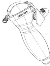
3. Поверните зажимные гайки биопсийной насадки с правой и левой стороны, чтобы зафиксировать насадку и датчик. Поверните гайку регулировки иглы в крайнее положение, как показано на рисунке.
